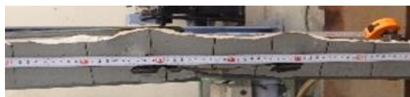
写真 6 試験体側面の変形状況 (年温度変化, 3 回目, 最大圧縮時)
