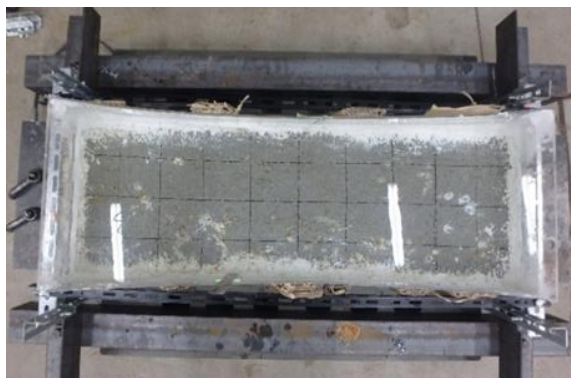
写真 9 水張試験 (最大引張状態)
