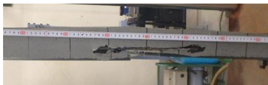
写真 2 試験体側面の変形状況 (日温度変化, 载荷回数 5000 回, 最大圧縮時)
