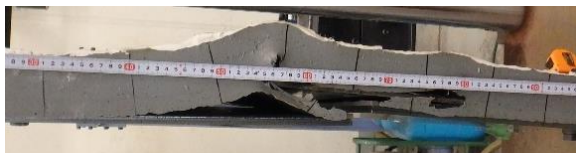
写真 7 試験体側面の変形状況 (年温度変化，16 回目，最大圧縮時)
