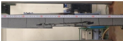
写真 1 試験体側面の変形状況 (日温度変化, 载荷回数 5000 回, 最大引張時)
