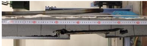
写真 4 試験体側面の変形状況 (年温度変化, 16 回目, 最大引張時)
