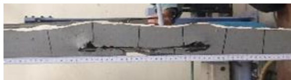
写真 5 試験体側面の変形状況 (年温度変化, 1 回目, 最大圧縮時)
