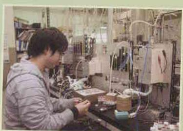
研究室では、膨大な組み合わせのなかから、ニッケルなどの金属を触媒として、その溶液を多孔質材料でできた担体に乗せる方法を開発。さらに実験を重ね、将来の実用化をめざします。
