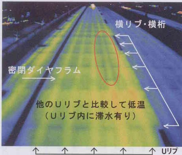
図4 舗装面上の高速走行による赤外線検査
